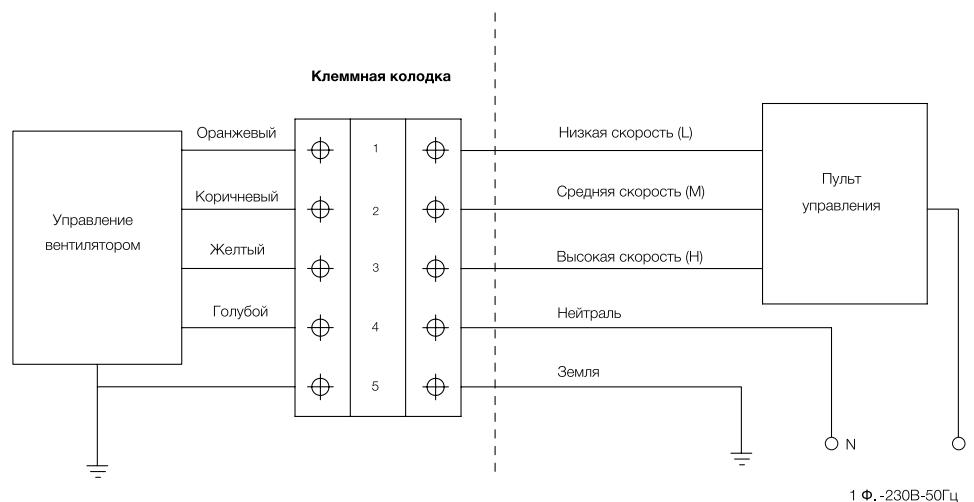
При подключении см. обозначения на клеммной колодке.
