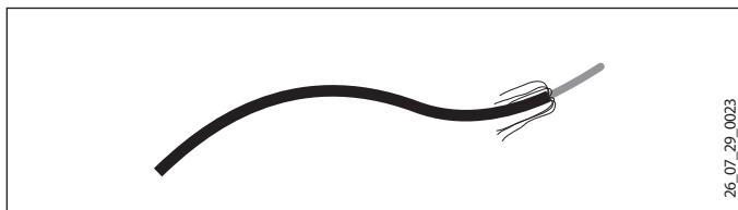
» Насадить входящий в комплект наконечник до упора на законцовку нагревательного провода.
