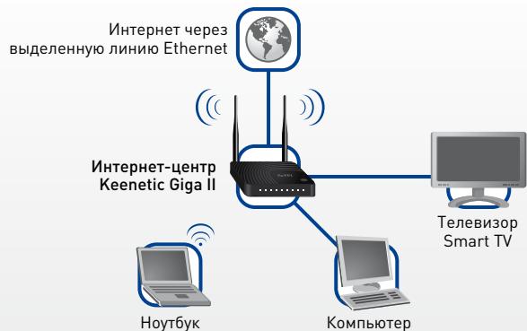
Подключение по выделенной линии Ethernet
