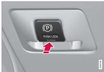
Ручка стояночного тормоза – тормоз задействован.
