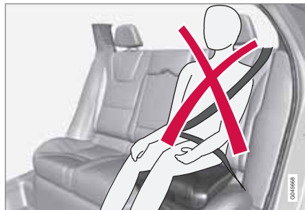
Неправильное положение: подголовник должен находиться на уровне головы, а ремень не должен лежать ниже плеча.
