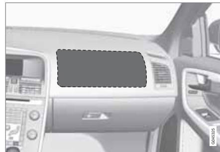
Расположение подушки безопасности на стороне пассажира в автомобиле с левосторонним управлением.
