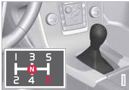
Схема переключения передач, 5-ступенчатая коробка передач.
