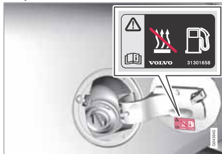
Предупреждающая табличка на крышке топливного бака.
