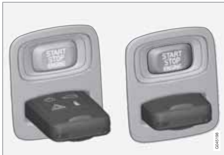
Замок запуска с выдвинутым/вставленным ключом зажигания.
