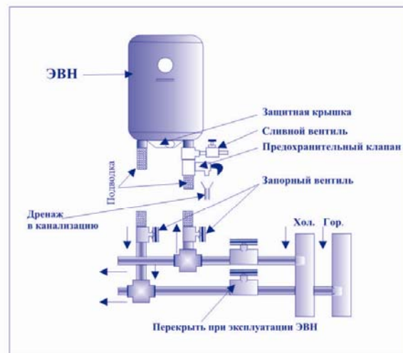
Рис.1. Схема подключения ЭВН к водопроводу
