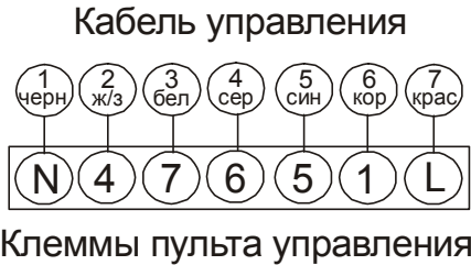
Рис.4. Схема подключения кабеля к пульту управления.
