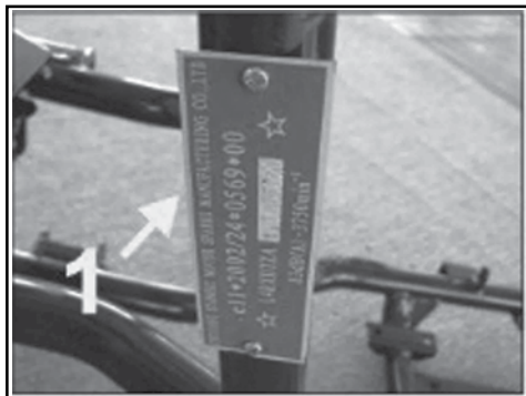
1. Заводская табличка с идентификационным номером на левой передней стороне рамы.
