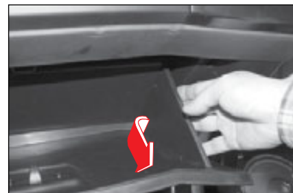
3. Потяните правую сторону перчаточного ящика в направлении стрелки.
