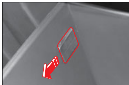
2. Снимите перчаточный ящик с панели приборов, перемещая левую сторону фиксатора в направлении стрелки.
