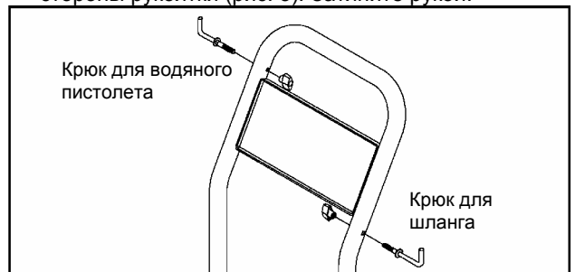
Рис. 3. Установка L-образных крюков на рукоятку.
