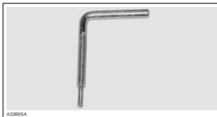
ИНСТРУМЕНТ ДЛЯ СНЯТИЯ/УСТАНОВКИ РЕМНЯ ВАРИАТОРА
