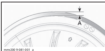
ПРЕДВАРИТЕЛЬНАЯ РЕГУЛИРОВКА 1. A = 0...2 мм
