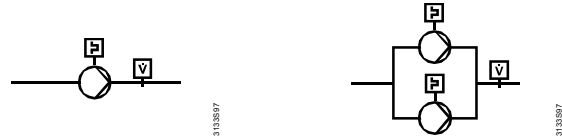
Управление одиночным насосом с наблюдением за протоком и перегрузкой мотора
