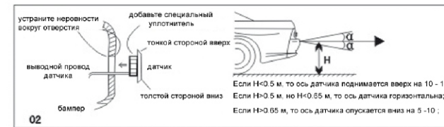
г) Регулирование угла наклона датчиков.
