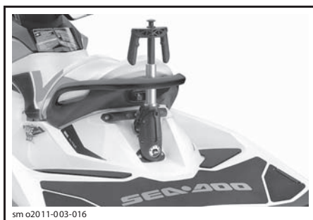
ТИПОВОЙ ВАРИАНТ — ПИЛОН ФАЛА ВОДНОЛЫЖНИКА/ВЕЙКБОРДИСТА ПОДНЯТ
