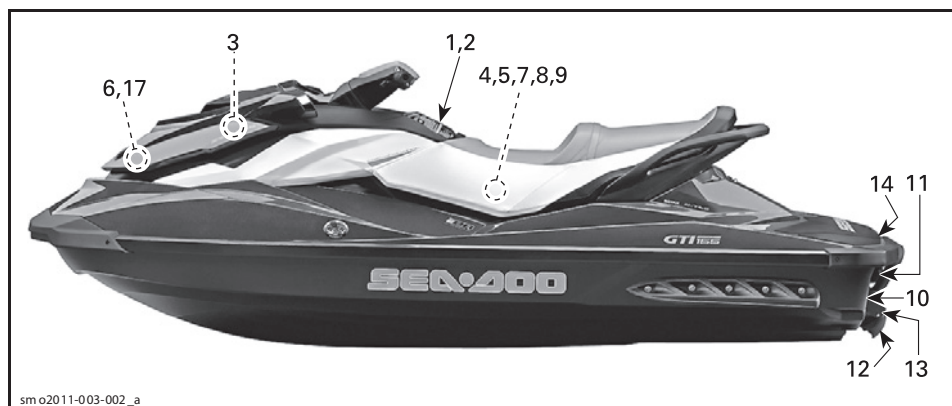
РАСПОЛОЖЕНИЕ ПРЕДУПРЕЖДАЮЩИХ ТАБЛИЧЕК — СЕРИЯ GTI
