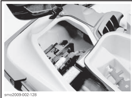
ДОСТУП К АККУМУЛЯТОРНОЙ БАТАРЕЕ И ПРЕДОХРАНИТЕЛЯМ — ПРАВЫЙ КОНТЕЙНЕР БАГАЖНОГО ОТДЕЛЕНИЯ СНЯТ
