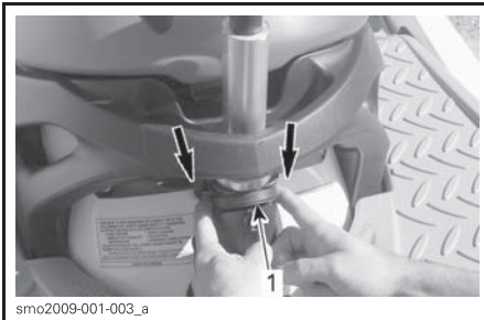
ЧТОБЫ ОСВОБОДИТЬ И ОПУСТИТЬ ПИЛОН, НАЖМИТЕ В НАПРАВЛЕНИИ НОСОВОЙ ЧАСТИ 1. Фиксатор
