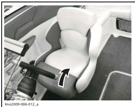
230 CHALLENGER — ПОДНЯТЬ ОПОРНУЮ ПОДУШКУ ВЕРТИКАЛЬНО
