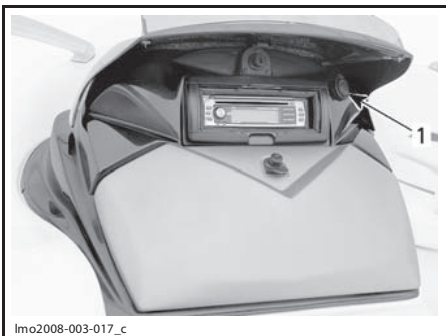
200 SPEEDSTER 1. Электрическая розетка 12 В
