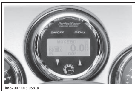
230 WAKE — СИСТЕМА КОНТРОЛЯ СКОРОСТИ PERFECT PASS
