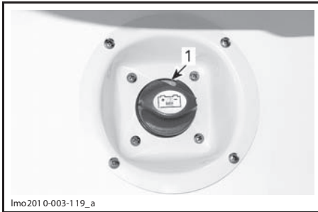
210 CHALLENGER — В ПОЛОЖЕНИЕ ON (вкл.) ДОЛЖЕН БЫТЬ ЗЕЛЁНОГО ЦВЕТА 1. Положение ON
