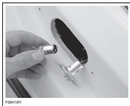
ТИПОВОЙ ВАРИАНТ — НАЖАТЬ, ПОВЕРНУТЬ И ИЗВЛЕЧЬ ЛАМПУ
