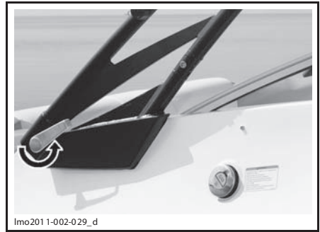
ПРАВАЯ СТОРОНА — ПОВЕРНИТЕ РУКОЯТКУ НА \frac{3}{4} ОБОРОТА ПРОТИВ ЧАСОВОЙ СТРЕЛКИ В ПОЛОЖЕНИЕ LOCK
