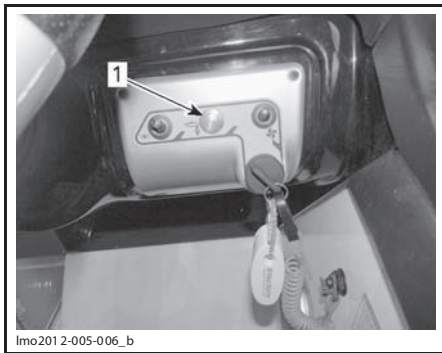
1. Выключатель системы очистки от водорослей
