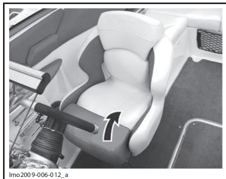
ТИПОВОЙ ВАРИАНТ — ПОДНИМИТЕ ОПОРНУЮ ПОДУШКУ
