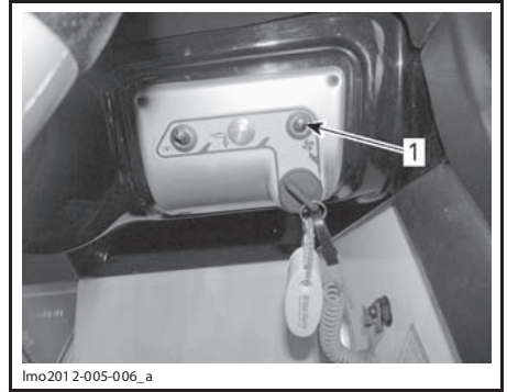
1. Выключатель трюмного вентилятора
