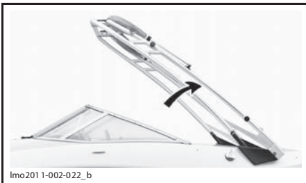
ТИПОВОЙ ВАРИАНТ — БАШНЯ ПОДНЯТА
