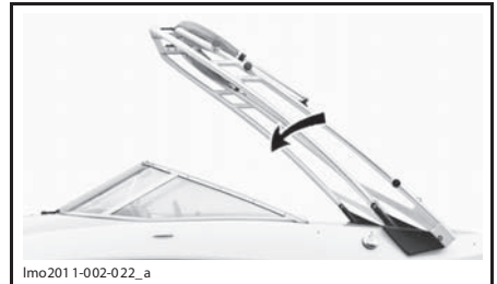
ТИПОВОЙ ВАРИАНТ — ОПУСКАНИЕ БАШНИ
