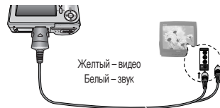
[Подключение аудио- и видеокабеля к фотокамере]
