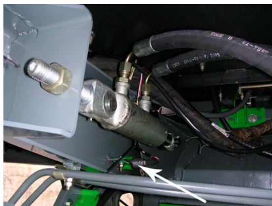
Рисунок 5.38 – Датчик сигнализации включения наклонной камеры– с правой стороны комбайна
