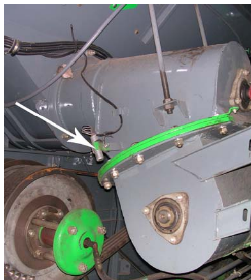
Рисунок 5.37-Датчик рабочего положения выгрузного шнека – на горловине выгрузного шнека
