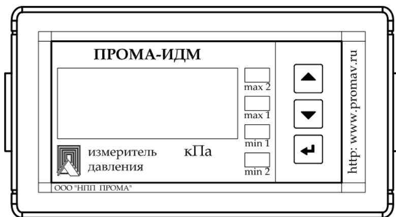
Рис.2б. Внешний вид измерителя ПРОМА-ИДМ-4х-Т исполнение «Щ» - щитовое (вид спереди).
