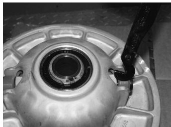
Вставьте загнутую часть инструмента внутрь.
