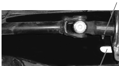
Доступ к штуцеру (вид сверху при снятой центральной панели)
