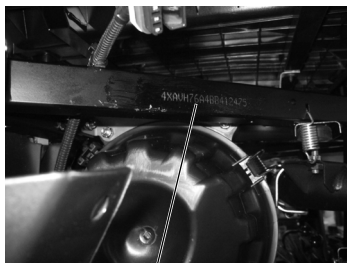
Табличка с VIN располагается под задним левым крылом около воздушного короба
