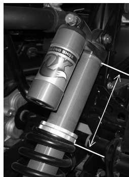
Измерение предварительной затяжки
