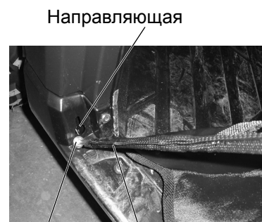
Шарнир Силовой элемент
