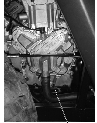
Расположение сливной пробки
