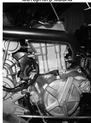
Масляной щуп (Проверка/доливка)
