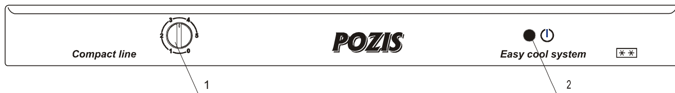
Рис.2. Регулировка температурного режима
