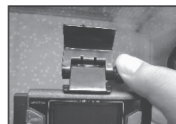
3. Ослабьте винт и установите требуемый угол наклона устройства, затем затяните винт обратно.
