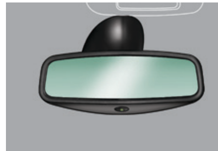
Зеркало заднего вида с автоматической регулировкой "день"/"ночь"
