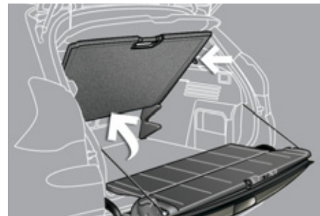
Переведите полку из верхнего положения в наклонное, при этом он опирается на два ограничителя, что облегчает доступ к нижнему отсеку и запасному колесу.
