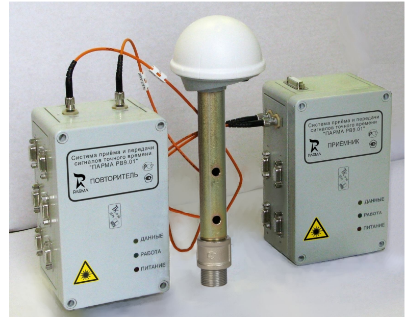
Внешний вид системы приема и передачи сигналов точного времени «ПАРМА РВ9.01»
