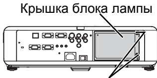
Крепежные винты крышки блока лампы
