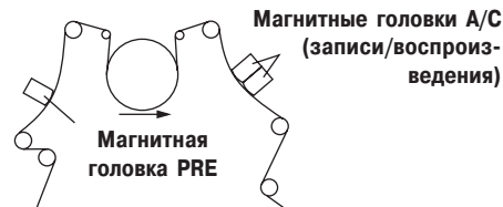
Схематичное изображение положения магнитных головок сигнала CTL
