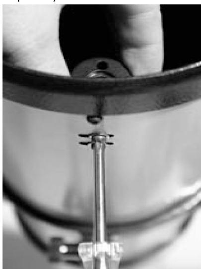
Рисунок 16а. Для регулировки коллимационной крышки, ослабьте два крестовых шурупа, удерживающих держатель вторичного зеркала.
