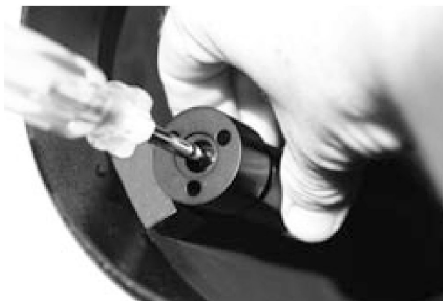
Рисунок 16b. Для регулировки положения вторичного зеркала в коллимационной крышке, ослабьте или затяните два крестовых шурупа в центре держателя зеркала, удерживая само зеркало.
