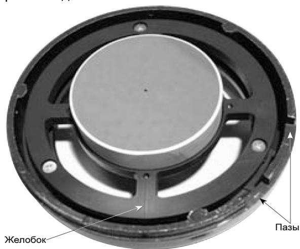
Рисунок 25. При установке корпуса зеркала после чистки первичного зеркала, ориентируйте желобок на внутреннем корпусе и выемки по краям корпуса, как показано на рисунке.
