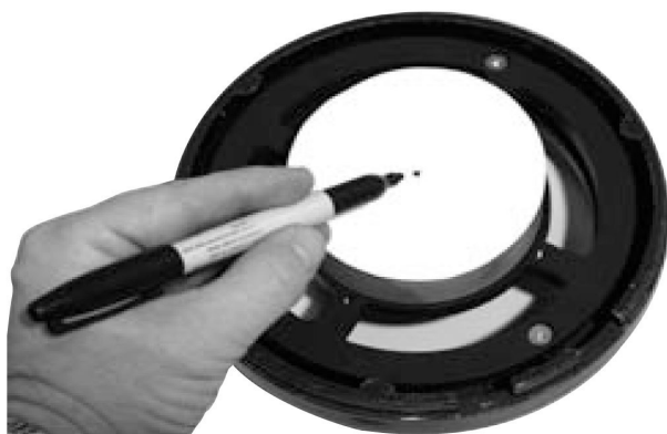
Рисунок 26. Если коллимационная метка сотрется в процессе очистки зеркала, то поставьте метку сами, с помощью обычного маркера.
