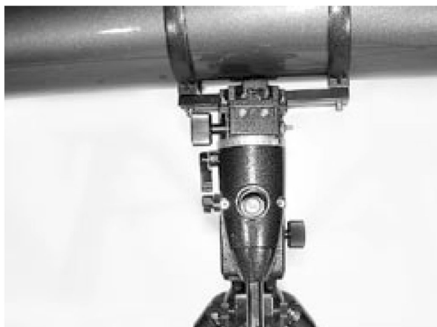
Рисунок 12. Для того чтобы смотреть в полярноосевой искатель, оптическая труба должна быть под углом 90^\circ к оси прямого восхождения.
