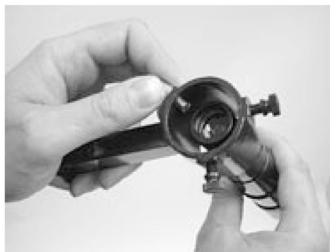
Рисунок 5b. Оттяните натяжитель и вставляйте искатель до тех пор, пока О-кольцо не окажется в кольце кронштейна.
