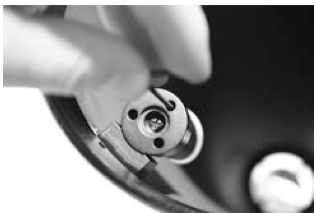
Рисунок 17. Наклон вторичного зеркала регулируется ослаблением или затяжкой трех регулировочных винтов в держателе зеркала.
