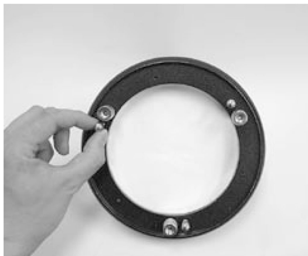
Рисунок 19. Прежде чем, что-либо регулировать, сначала нужно ослабить три маленьких винта, удерживающих первичное зеркало. Потребуется плоская отвертка.
