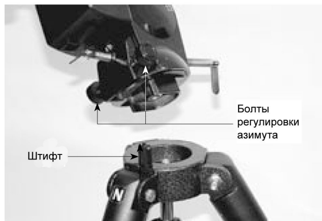
Рисунок 2. Расположите экваториальную монтировку так, чтобы штифт на верхней части треноги оказался между болтами регулировки азимута на экваториальной монтировке.
