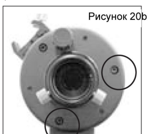
Рисунок 20b. Теперь 3 мм ключом поверните по часовой стрелке, не более, чем, на четверть оборота два соседних больших винта
