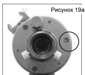
Рисунок 19а. Используя 3 мм универсальный ключ, поверните большой винт по часовой стрелке не более, чем на четверть оборота. (примечание: какой винт необходимо повернуть - это зависит от конкретного случая)
