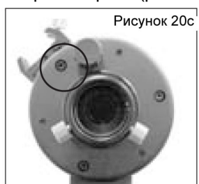
Рисунок 20c. Поверните по часовой стрелке большой винт, который находится точно напротив винта, который Вы регулировали первым.
