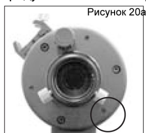
Рисунок 20а. Используя 2 мм универсальный ключ, поверните маленький винт против часовой стрелки не более, чем на четверть оборота. (примечание, какой винт необходимо повернуть - это зависит от конкретного случая).
