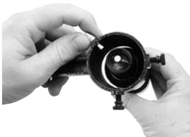
Рисунок 3б. Оттяните натяжитель и вставляйте искатель до тех пор, пока O-кольцо не окажется в кольце кронштейна.
