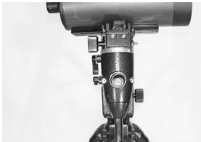
Рисунок 10. Для того чтобы смотреть в полярноосевой искатель, оптическая труба должна быть под углом 90^\circ к оси прямого восхождения.
