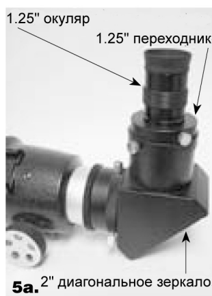
Рисунок 5а и 5б. Для использования 1.25" окуляров в 2" диагональном зеркале должен быть установлен 1.25" переходник. 5б. Для использования 2", снимите 1.25" переходник.
