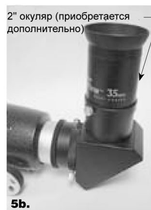
Рисунок 5а и 5б. Для использования 1.25" окуляров в 2" диагональном зеркале должен быть установлен 1.25" переходник. 5б. Для использования 2", снимите 1.25" переходник.
