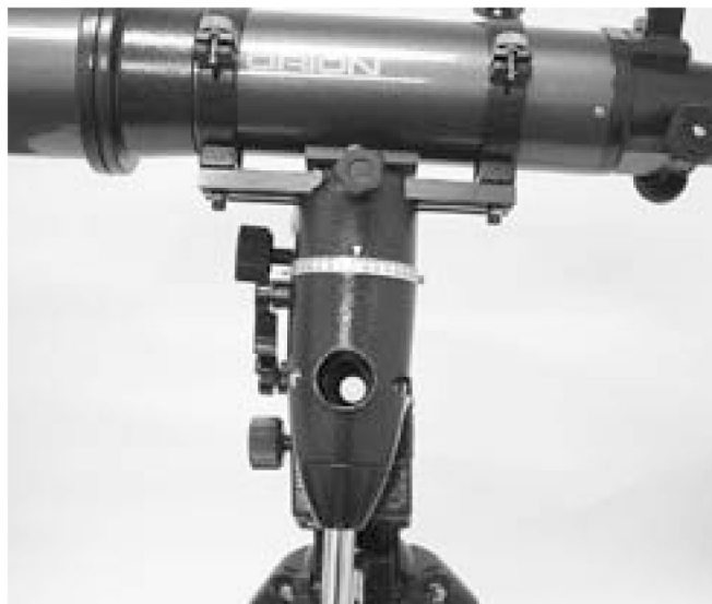
Рисунок 12. Для того чтобы смотреть в полярноосевой искатель, оптическая труба должна быть под углом 90^\circ к оси прямого восхождения.
