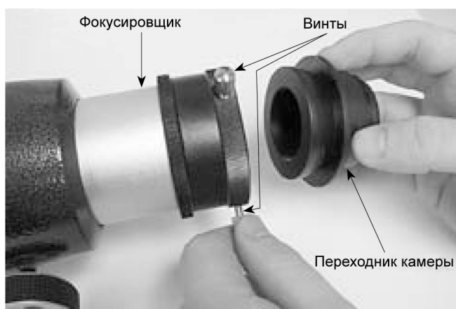
Рисунок 4. Перед установкой 2" диагонального зеркала снимите сначала переходник камеры.
