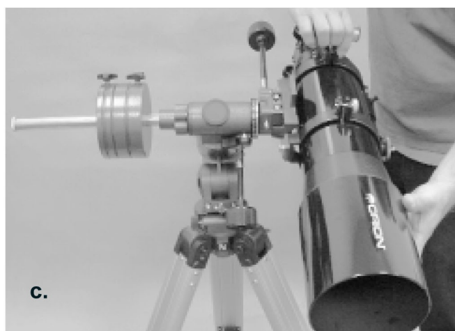
Рисунок 5. Для правильной работы экваториальной монтировки необходимо отбалансировать трубу на оси прямого восхождения и склонения (а). Ослабив ручку фиксации прямого восхождения, сдвигайте противовесы по стержню, до тех пор, пока они не уравновесят трубу (б). Если Вы отпустите обе руки, телескоп должен оставаться неподвижным (с). Ослабив ручку фиксации склонения и кольца крепления трубы, сдвигайте телескоп вперед или назад, уравновесьте его и по оси склонения (д).
