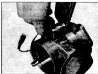
7.7а Соединительный винт конденсатора/вакуумного блока
