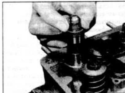
34.43 Установка гидротолкателя клапана в головку блока цилиндров
