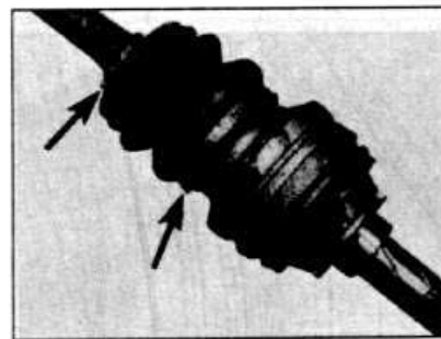
3.1 Крепежные скобы защитного чехла внутреннего соединения приводного вала (отмечены стрелками)
