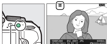
Кнопка \text{AE-L/AF-L} ( ОП )
