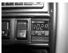
Пример установки прибора на консоли в салоне автомобиля ГАЗ 3110
