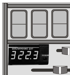
Пример установки прибора на консоли в салоне автомобиля ГАЗ 3110
