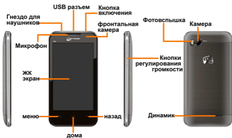
Рис.1. Общий вид смартфона
