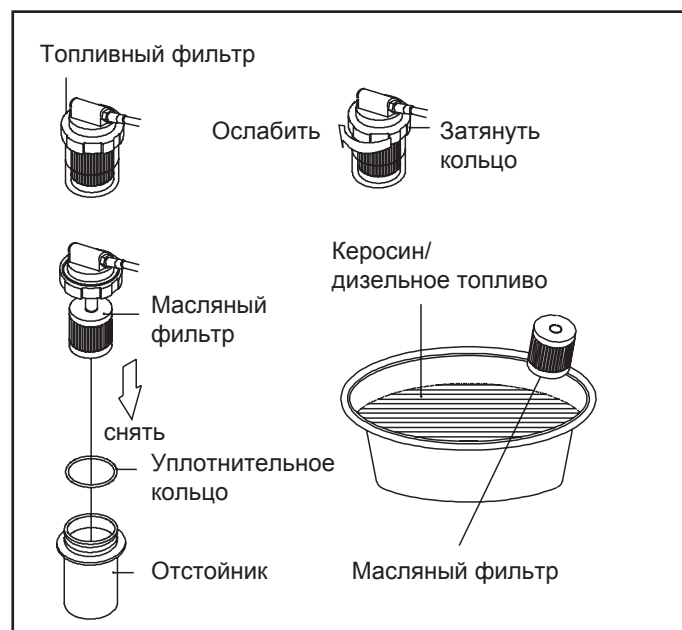
Рис 6. Обслуживание фильтра
