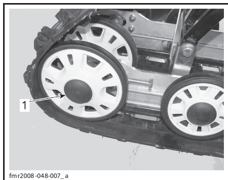
1. Колпачок правого заднего направляющего катка
