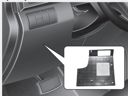
Внутренняя панель плавких предохранителей
