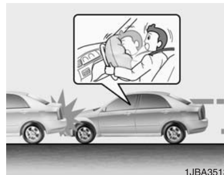
Условия срабатывания воздушной подушки
