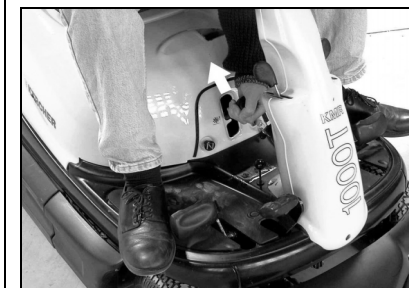
Podići valjak za smeće
