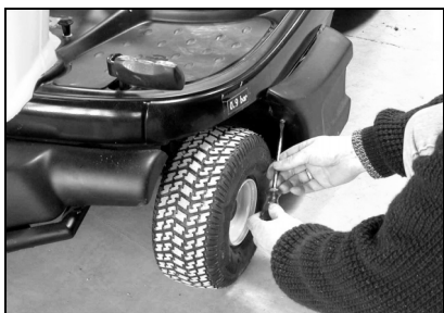
Retirar as coberturas.
