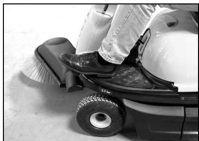
Nadvihnúť bočné metly ➤ Stlačte pedál a aretáciu zaistíte prostredníctvom osadenia
