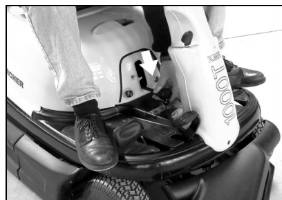
Χαμηλώστε τον κύλινδρο σκουπίσματος
