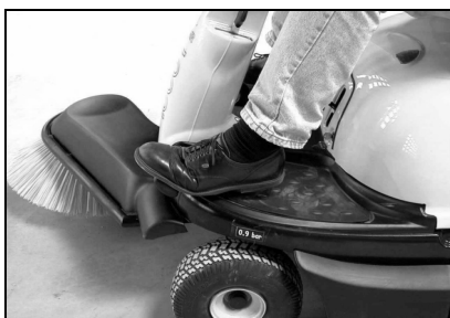
Abbassare le scope laterali
