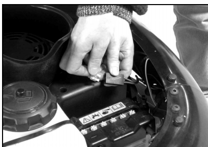
Sikringshuset løsnes fra udsparingen.
