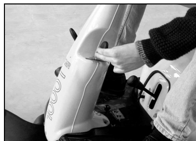
Skubbedrift (N) Kørselsretningsstang i stilling "N"
