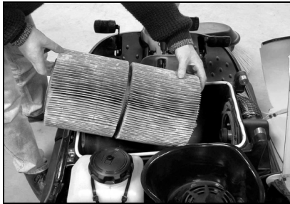
Colocar o novo filtro do pó na centragem.
