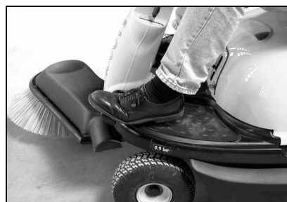
Χαμηλώστε τον κύλινδρο σκουπίσματος
