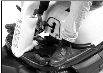
Dra i choken (Endast om motorn är kall)
