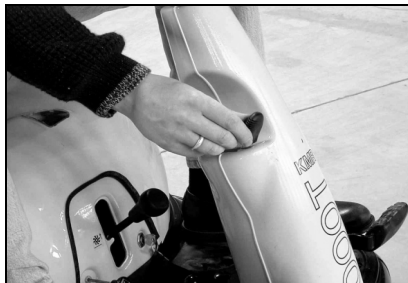
Stil gasforindstillingen på "Hare"
