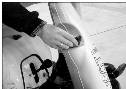
Prednastavenie plynu nastavte na značku zajaca
