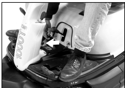
Træk chokeren ud (kun når motoren er kold)
