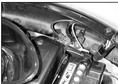
Sikringshuset løsnes fra udsparingen.
