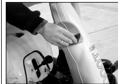
Podesiti gas na zapinjaču
