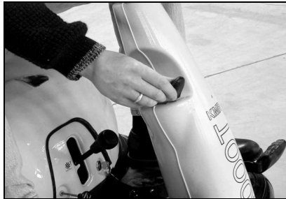
Gasinstelling op "Haas" zetten
