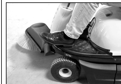
Podići bočnu metlu ➤ Pritisnuti pedalu i blokirati je
