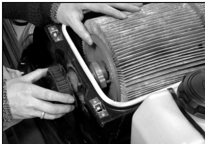
Colocar a fixação do filtro do pó.
