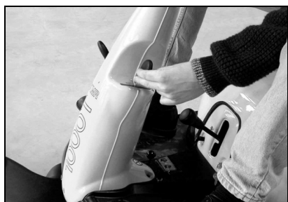
Λειτουργία όταν σύρεται (N) Μοχλός κατεύθυνσης πορείας στη θέση "N"
