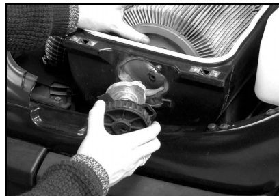
Skinuti pričvršćenje filtra za prašinu.
