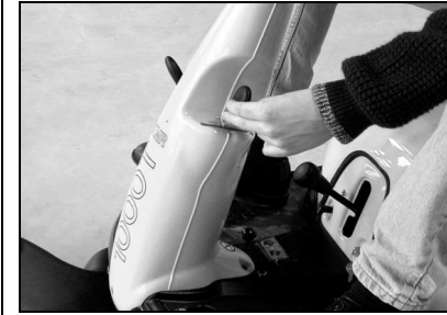
Työntökäyttö (N) Ajosuuntavipu asennossa "N"
