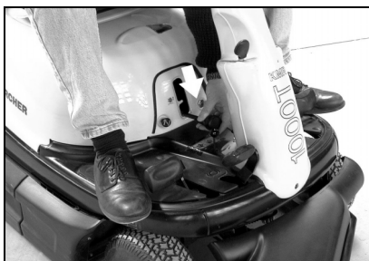
Abbassare il rullo di spazzatura
