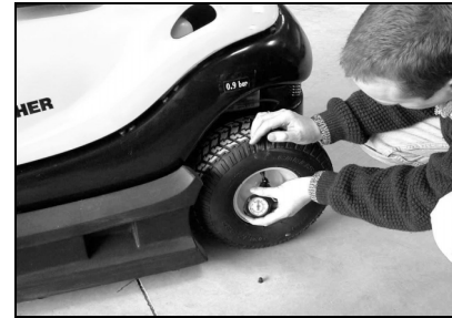
A pressão de ar dos pneus de trás tem de ser ajustada para 0,9 bar.
