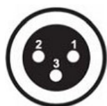
DMX – выход панельный разъем XLR «мама»
