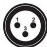
DMX – вход панельный разъем XLR «папа»
